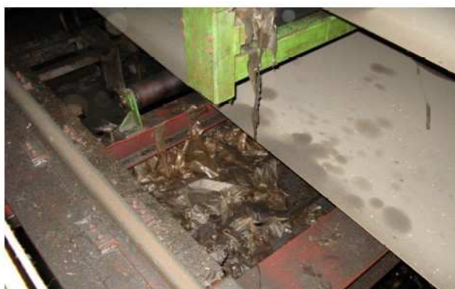
Immagine 36 – “Carta impressa” sul tetto della saldatrice, staccatasi dalla lamiera in transito sul carro di accumulo in ingresso.
